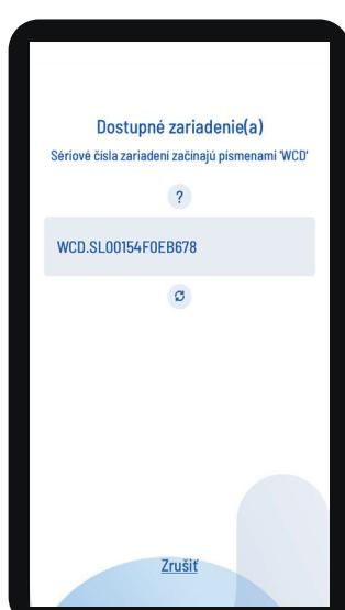
5. Na obrazovke aplikácie sa zobrazí zoznam dostupných zariadení. Zoznam by mal obsahovať názov, ktorý sa začína na **WCD** a za ním nasleduje sériové (výrobné) číslo. Ide o tento zmäkčovač. Po výbere názvu sa na obrazovke zobrazí hlásenie **Párovanie vášho zariadenia**.
