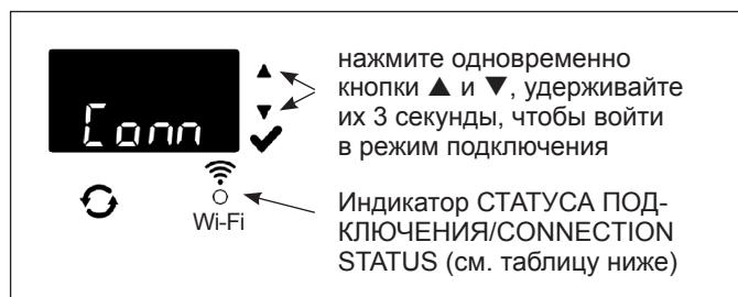
4. Отпустите кнопки, когда на дисплее отобразится „Conn“ (Подключение) (см. Рисунок выше), а индикатор статуса подключения замигает желтым.
