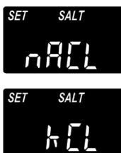
1. Po provedení předchozího kroku se na displeji zobrazí nápis „NaCl“ (chlorid sodný) nebo „KCl“ (chlorid draselný). V opačném případě mačkejte ✓ OK, dokud se neobjeví.
